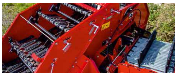
Ручная регулировка: 6 очищающих гребенок на транспортере крупной ботвы
