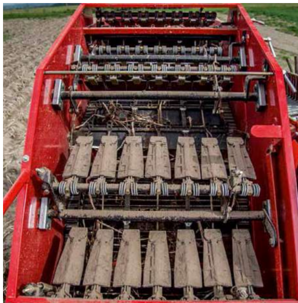
Бережное отношение: транспортер крупной ботвы с мягкими полиуретановыми скребками (расстояние 210 мм)
