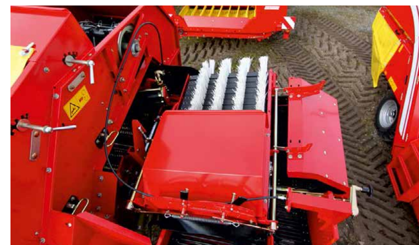
Сепарирующее устройство варианта SB: для каменистых почв
