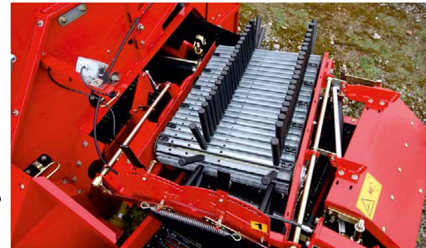
Скорость пальчикового транспортера регулируется гидравлически и бесступенчато.
