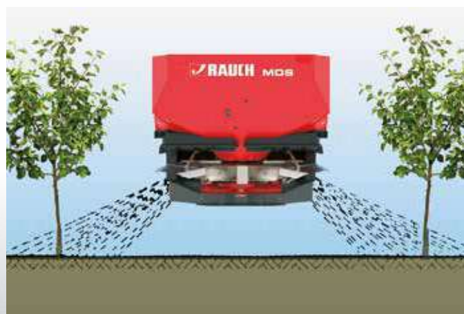
Принцип действия приспособления для разбрасывания по рядам RV 2M
