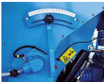
Бесступенчатый редуктор в масляной ванне
