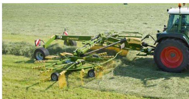
Валкователи с центральной укладкой валка Swadro TC и TC Plus Изменяемая ширина захвата от 5,70 м до 10,00 м
