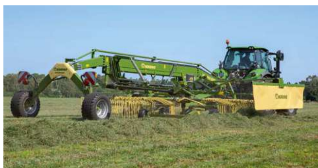
Валкователи с боковой укладкой валка Swadro TS 970 ширина захвата 9,70 м
