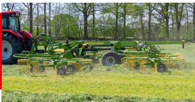
Валкователи с центральной укладкой валка Swadro TC 1250 Изменяемая ширина захвата от 9,80 м до 12,50 м
