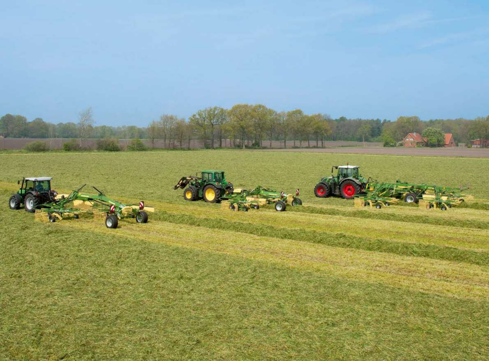
Валкователи с центральной укладкой валка Swadro TC 1250 Изменяемая ширина захвата от 9,80 м до 12,50 м
