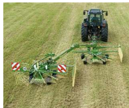
Укладка двух валков слева
