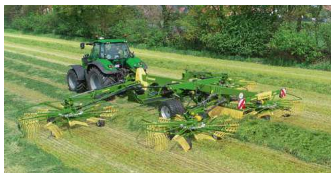
Валкователи с центральной укладкой валка Swadro TC 1370 Изменяемая ширина захвата от 10,80 м до 13,70 м
