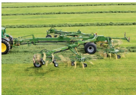
Шестироторные валкователи с центральной укладкой валка Swadro 2000 Изменяемая ширина захвата от 11,00 м до 19,00 м
