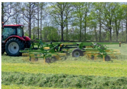
Четырехроторные валкователи с центральной укладкой валка Swadro TC 1250 Изменяемая ширина захвата от 9,80 м до 12,50 м
