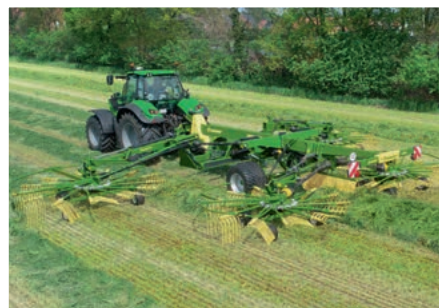
Четырехроторные валкователи с центральной укладкой валка Swadro TC 1370 Изменяемая ширина захвата от 10,80 м до 13,70 м
