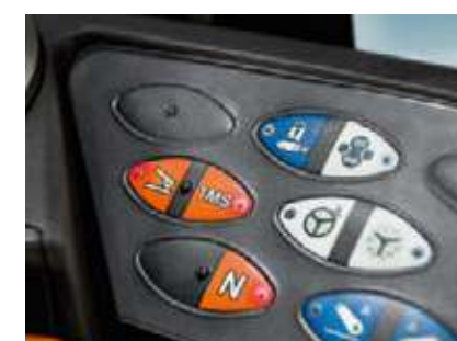
Все функции просто и доступно расположены на клавиатуре с подсветкой, в соответствии с проверенной временем логической схемой управления Fendt.
