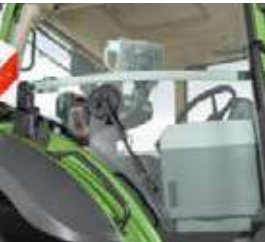
Стеклоочиститель бокового стекла с охватом в 220° даже при сложных условиях обеспечивает отличный обзор с правой стороны.
