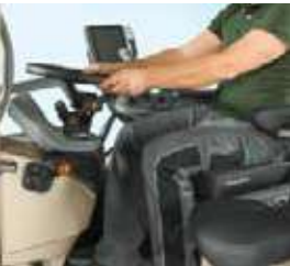
Для еще большего удобства управления передняя панель наклонена параллельно рулевому колесу.
