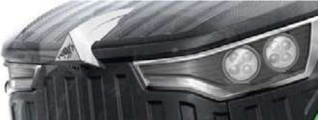
Светодиодные дневные ходовые огни и рабочие фары встроены вместе с камерой в переднюю часть капота.
