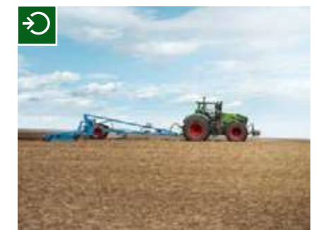
Благодаря системе управления трактором TMS и автоматической системе регулировки предельной нагрузки 2.0, трактор подбирает оптимальные обороты двигателя к текущей скорости движения.
