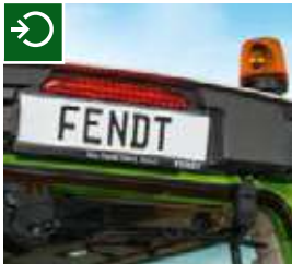
Fendt Vario 1000 оснащен третьим стоп-сигналом, повышающим безопасность движения по дороге.
