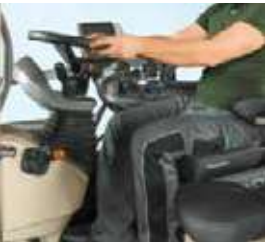
Для еще большего удобства управления передняя панель наклонена параллельно рулевому колесу.
