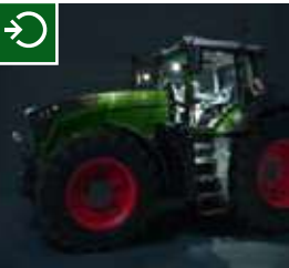
При использовании функции Coming-Home фары и освещение ступенек работают после остановки двигателя, чтобы осветить дорогу и ступеньки.
